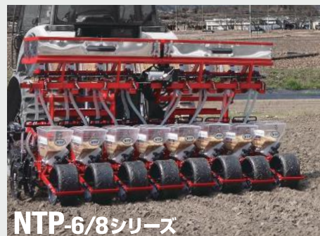
NTP-6/8シリーズ 水稲乾田直播の高速(最大8km/h)高精度点播を実現。
