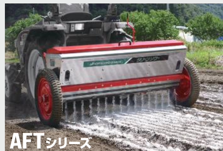
AFTシリーズ 石灰の大量散布から化成肥料の散布まで対応。
