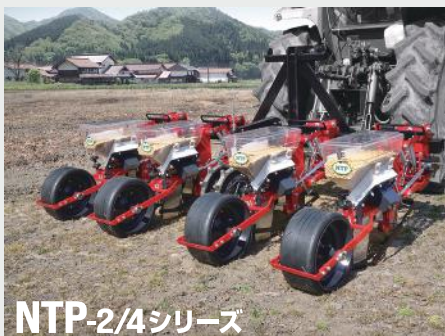
NTP-2/4シリーズ 飼料用作物に適した不耕起圃場対応の高速播種機。
