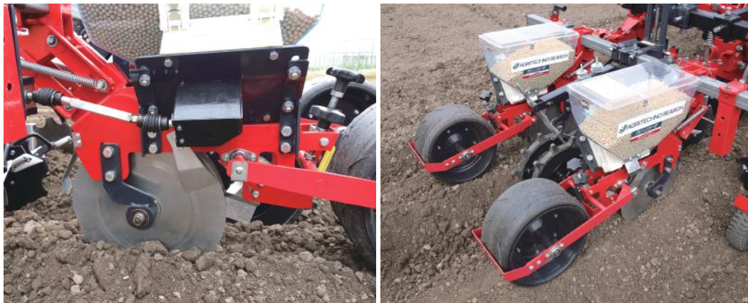
写真は小橋工業株式会社の高速畝立てディスク「HDR200」に弊社の大豆用高速播種機「HUD-2」を装着した、大豆用高速畝立て播種機の状態です。
